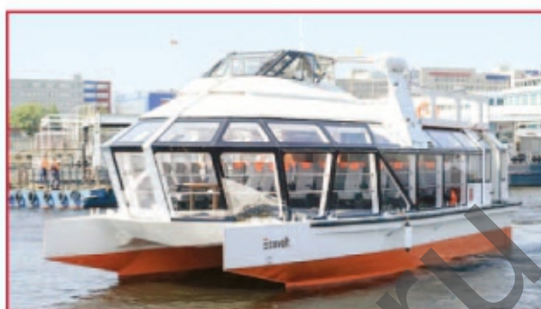
Электрическое пассажирское судно пр. 401001 (вместимость – 84 пассажира, автономность хода – 8 ч, скорость – до 7 узл.)
