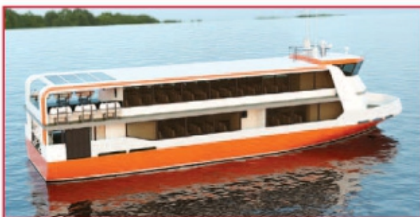
Модель пассажирского судна пр. МПКС (длина – 31,95 м, ширина – 8,14 м, вместимость – 240 пассажиров, осадка – 1,4 м, мощность – 2x225 кВт)
