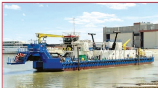
Самоходный земснаряд пр. 93.159А с роторным рыхлителем, монопонтонного типа, с погружным грунтовым насосом на раме ротора.
